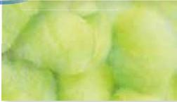
Los medios de filtrado mecánicos se componen de fibras sintéticas que retienen la suciedad de forma mecánica. En función de su permeabilidad, se diferencia entre medios de filtrado finos y gruesos.
