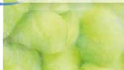
Os materiais filtrantes mecânicos são compostos por fibras sintéticas e retêm a sujidade de modo mecânico. Existem materiais filtrantes finos e grossos que se distinguem em função da permeabilidade.
