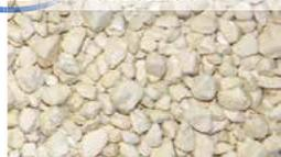
Os materiais filtrantes absorventes são granulados que, dependendo dos componentes ativos utilizados, podem absorver diversas substâncias poluentes.
